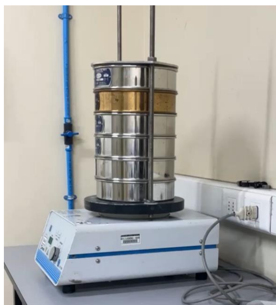
Figura 3.2. Disposición tamices Ro-Tap. (Elaboración propia)
