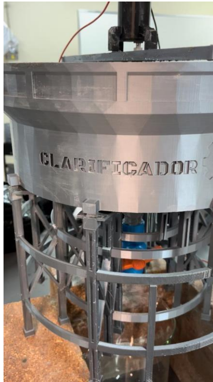
Figura 4.7. Clarificador 2 impreso en 3D. (Elaboración propia)
